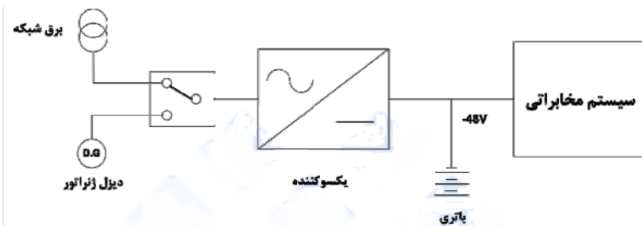
شکل ۱- برق DC حاصل از تبدیل AC به DC (یکسو کننده)
